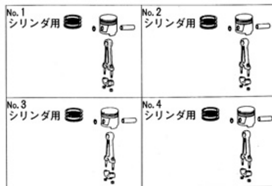
図0-2-5 取りはずし部品の点検、整理
