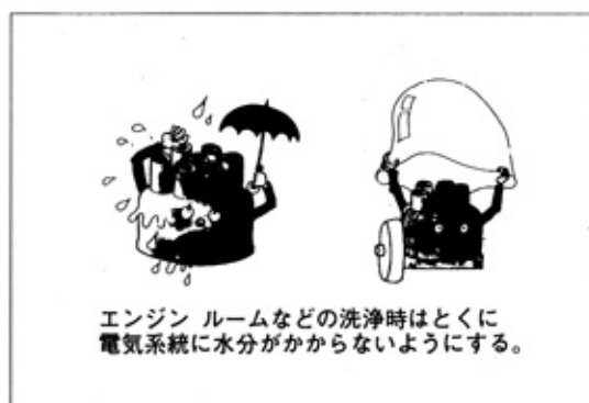
図0-2-6 エンジン ルームの洗浄
